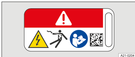
Bilde 4 Varselskilt på høyvoltagekomponenter.
